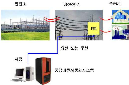
그림 1 배전자동화 시스템의 기본 구성 Fig. 1 Constitution of DAS
